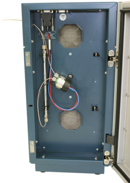
図 15-14: フローセルの取り付け
