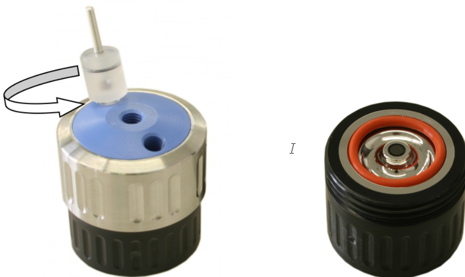
図 15-16: 左側 : 塩橋電極のネジを外す。右側 : Oリング溝に Oリングを配置した WE ブロック
