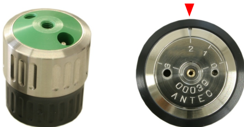
図 15-10: 左側 : In-situ Ag/AgCl (ISAAC) 参照電極 (REF) を搭載した組み立て済み SenCell インレットブロック (緑) の写真。右側 : セル動作容量調節システム、補助 (AUX) 電極接点 (左側開口部、刻印「3」の隣)、作用電極 (WE) 接点 (中央の開口部) のある SenCell の底部。
