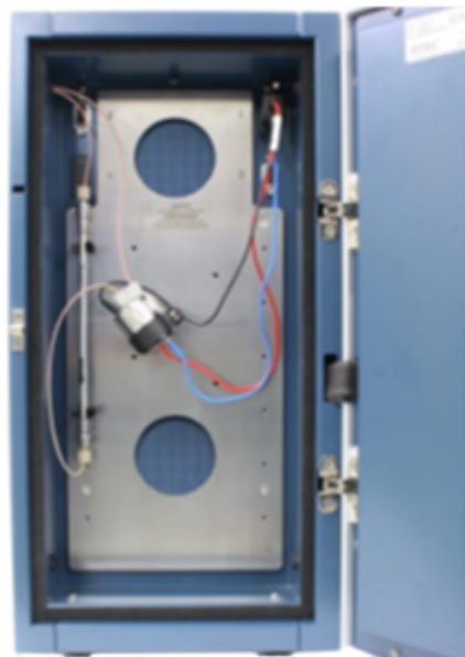
図 2-7: 3465 検出器のフローセルとカラムの取り付け
