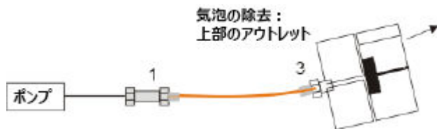
図 16-19: 低デッドボリュームコネクタ (1) を使用して、200~400 \mu\text{L}/\text{分} で VT-03 マイクロフローセルに充填します。圧力は 200 bar を超えてはなりません。
