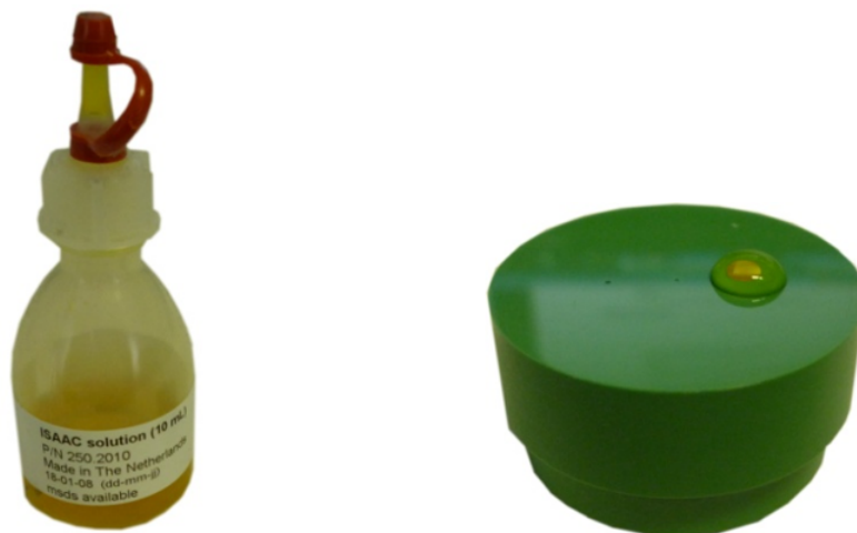
図 15-18: 左側:ISAAC 溶液。右側:新たに研磨した参照電極に ISAAC 溶液を塗布した ISAAC インレットブロック
