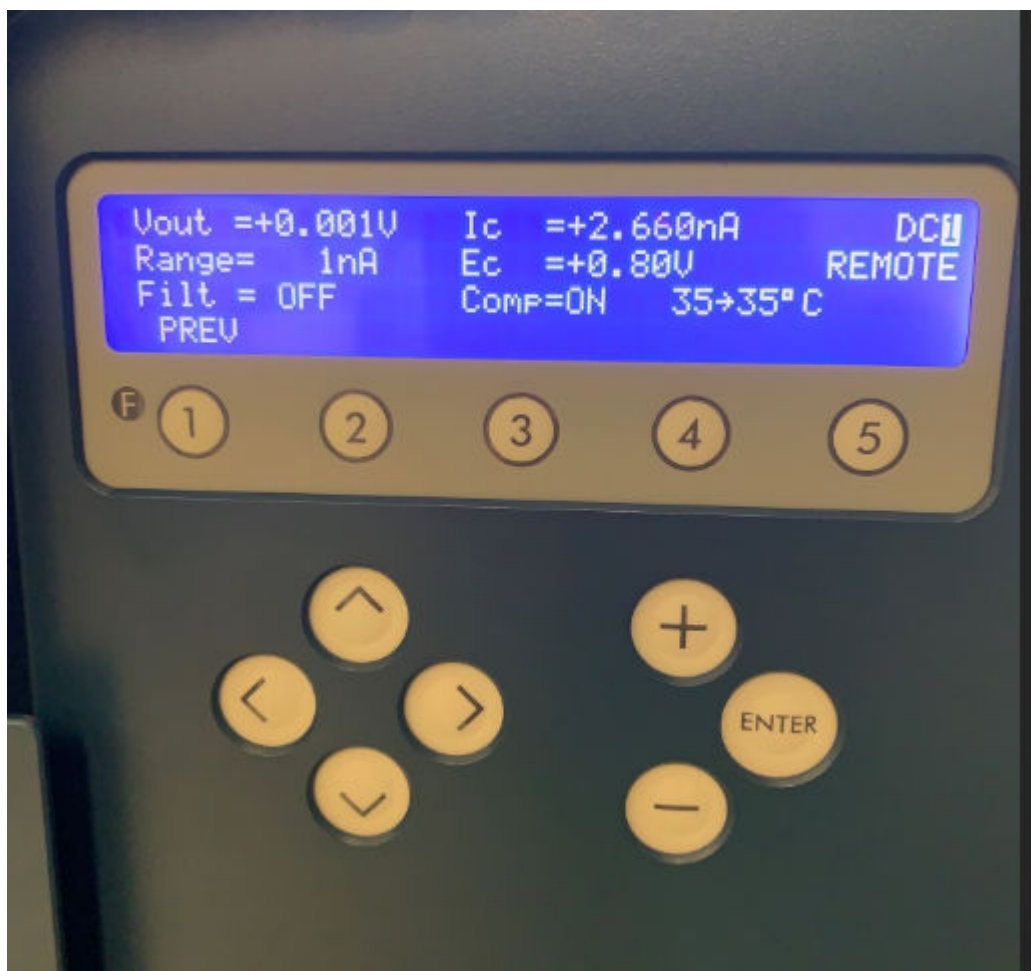
図 4-1: 3465 検出器キーボード。カーソルは「Range」(範囲) にあり、値ボタン「+」と「-」を使用して変更できます。Enter ボタンは、電位 (Ec) と範囲の確定のみに使用できます。
