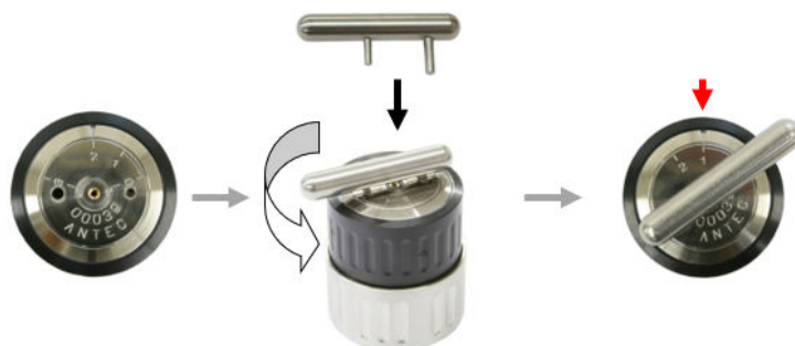
図 15-11: 位置 2 (左) から位置 1 (右) への動作容量の調整
